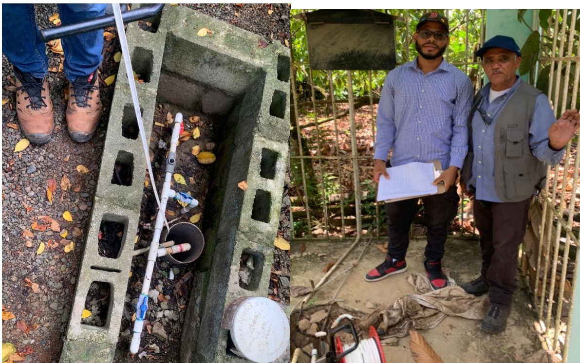
Foto 10: Medición de la profundidad estática del pozo mediante cinta piezométrica.
