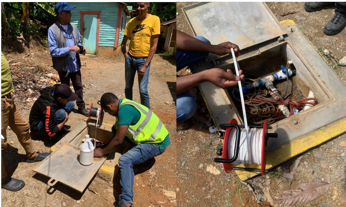
Foto 10: Medición de la profundidad estática del pozo mediante cinta piezométrica.
