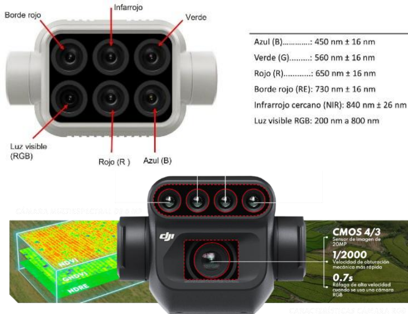
Figura 5. Sensor multispectral para análisis de cultivos y gestión de vegetación en agricultura de precisión (superior), cámara multispectral DJI Mavic 3M (inferior).
