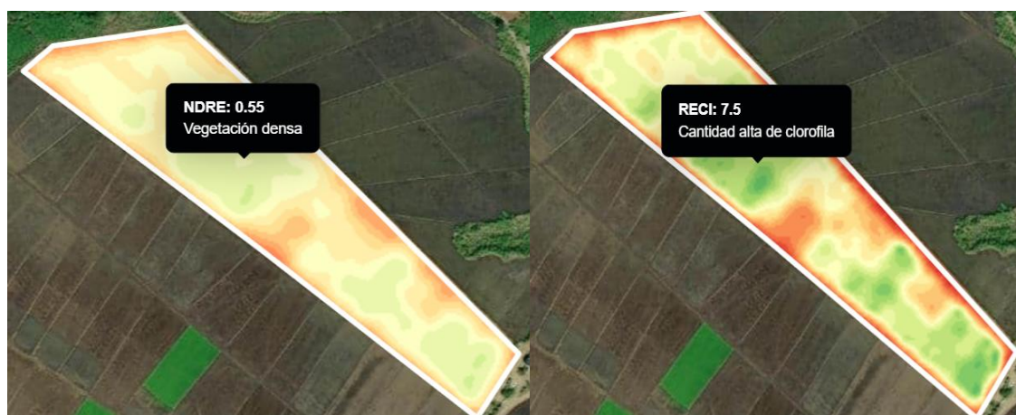
Figura 40. Distribución espacial de NDRE (izquierda) y RECI (derecha) estimados a partir de imágenes satelitales, como indicadores del contenido relativo de clorofila del dosel, para evaluar el estado fisiológico del arroz ( Oryza sativa L.) en finca Jima Arriba.
