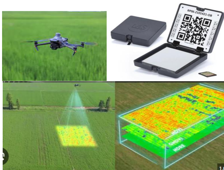
Figura 10. DJI Mavic 3 Multispectral y placa de calibración reflectante Micasense utilizada para garantizar la consistencia radiométrica de las imágenes multispectrales.
