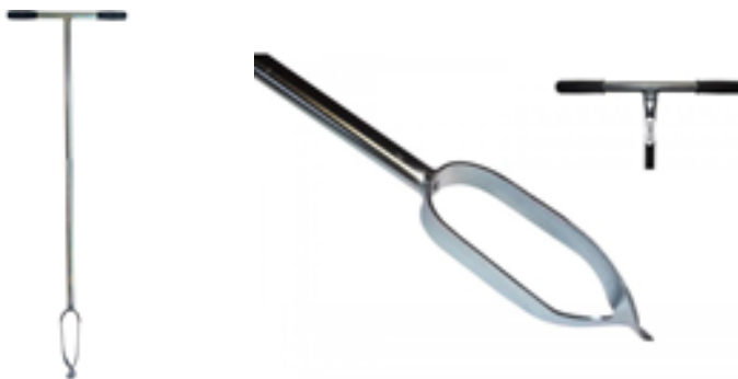
Figura 9. Instrumento utilizado para el muestreo de suelo: barreno Edelman. Fuente: Recursos de Google (2025).
