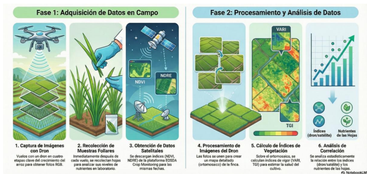
Figura 12. Representación esquemática para la obtención de mapeo de nutrientes en arroz con drones y satélites.
