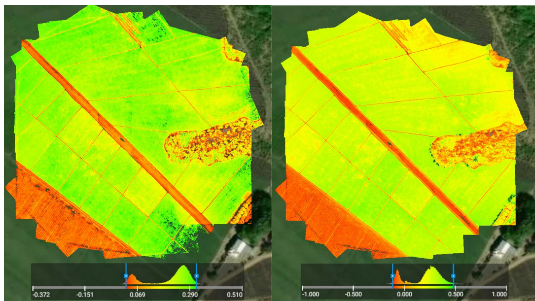
Figura 25. Índices visibles (RGB) de vigor: TGI ( Triangular Greenness Index ) (izquierda) y VARI ( Visible Atmospherically Resistant Index ) (derecha) correspondientes a la etapa vegetativa (macollamiento) del cultivo de arroz ( Oryza sativa L.), obtenidos en el vuelo 1 realizado con RPAS en finca Jima Arriba.
