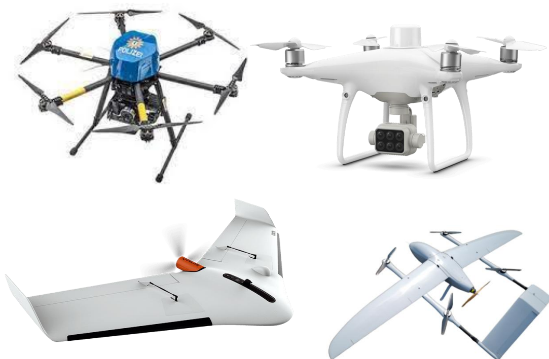
Figura 3. Dron agrícola de ala giratoria (multirrotor, hexarrotor) para monitorización y fotografía aérea (Izquierda-arriba); dron DJI Phantom 4 Multiespectral (derecha-arriba); dron de alas fijas (izquierda-abajo) y dron híbrido (derecha-abajo).
