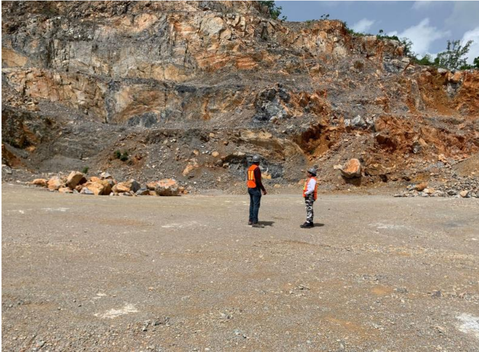
Figura 25: inspección de zonas de riesgos geotécnicos en frentes de extracción de material. Calizamar, S.A. SR_Caballeros
