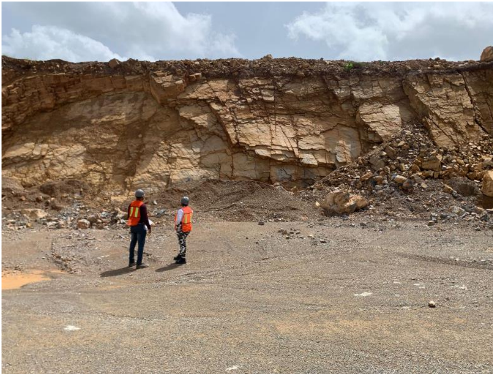
Figura 25: inspección de zonas de riesgos geotécnicos en frentes de extracción de material. Calizamar, S.A. SR_Caballeros
