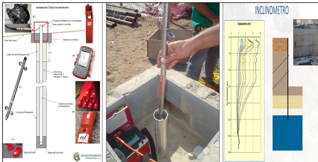
Figura 15: Instalación, lectura y data de un inclinómetro
