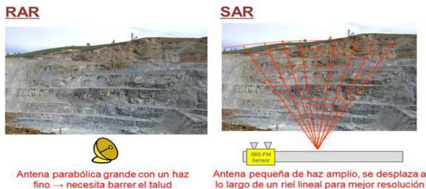
Figura 4: Tecnologías de radar terrestre SAR – RAR
