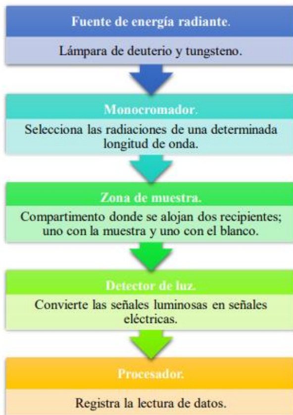
Fig. 3.3.1.1.1 Componentes del espectrómetro UV-Visible
