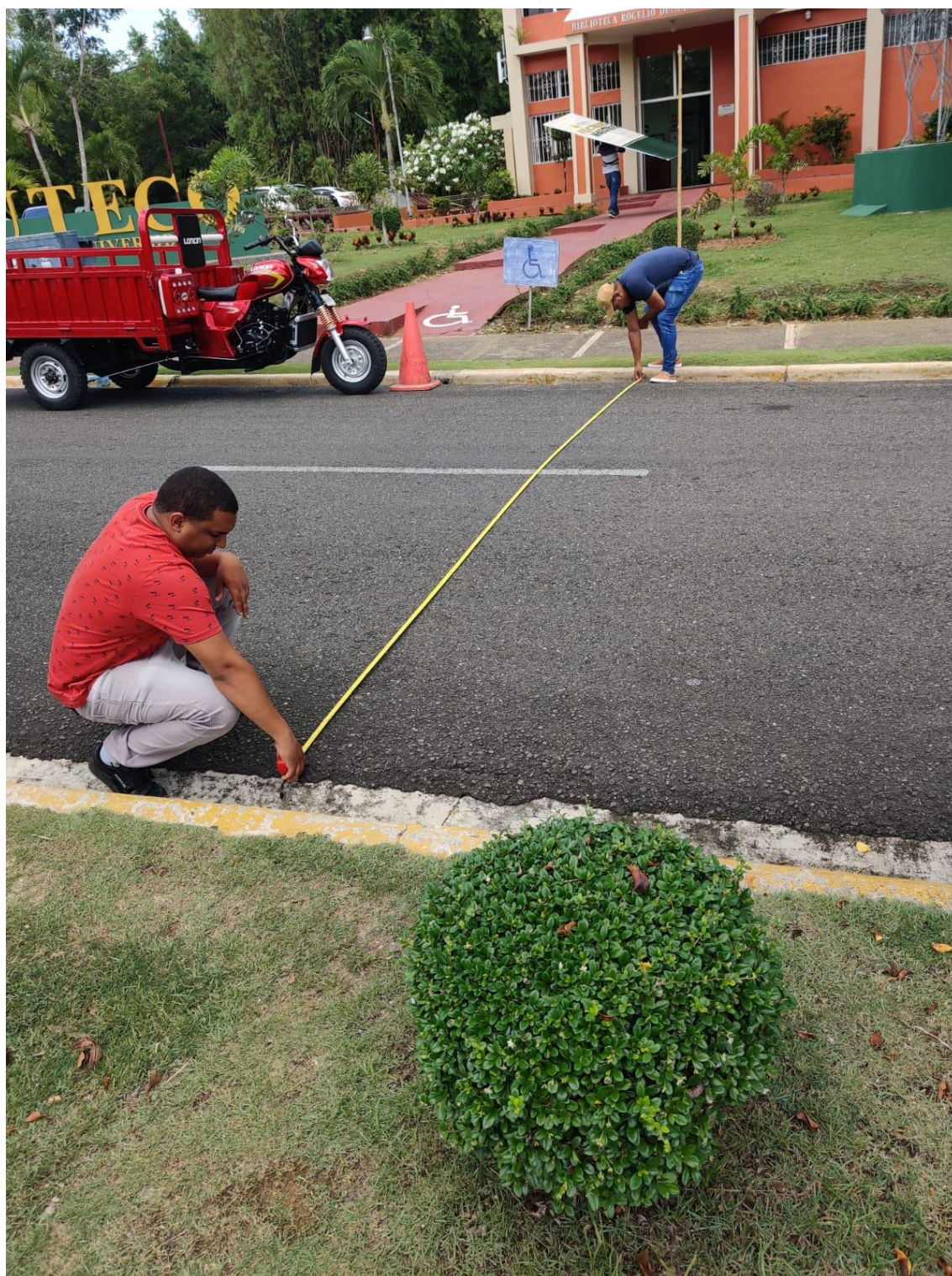
Fuente: Equipo de ingenieros investigadores en el campus realizando evaluación del ancho de la vía para el desarrollo del proyecto.
