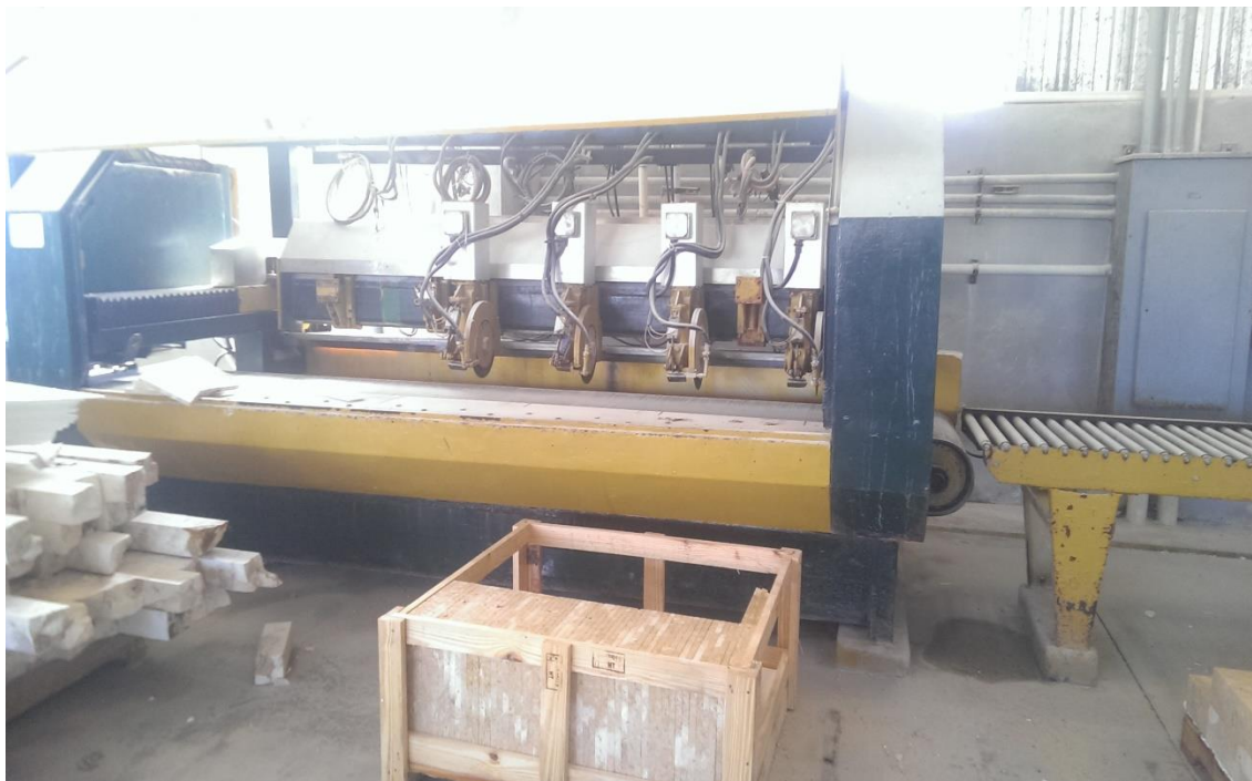
Fresa puente en la planta de Boriquen Coral Stone.
