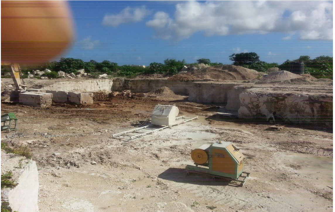
Máquina de hilo diamantado en una de la cantera de Coralina Del Este.
