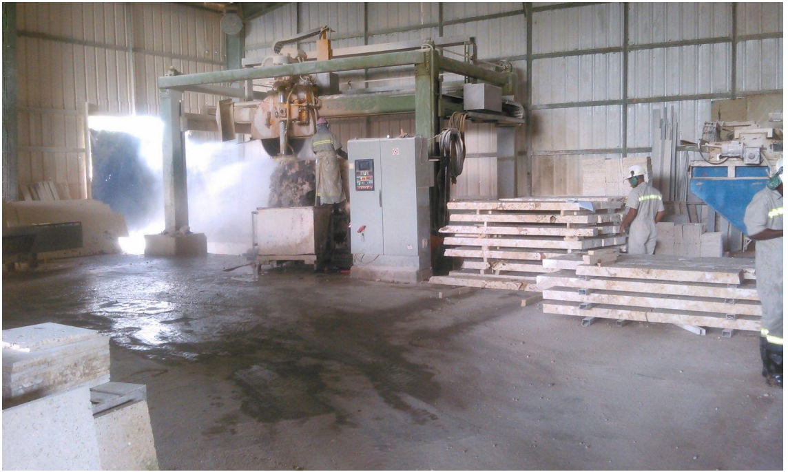
Corta bloque con su descabezadora en la planta de La Ensenada Coral Stone.
