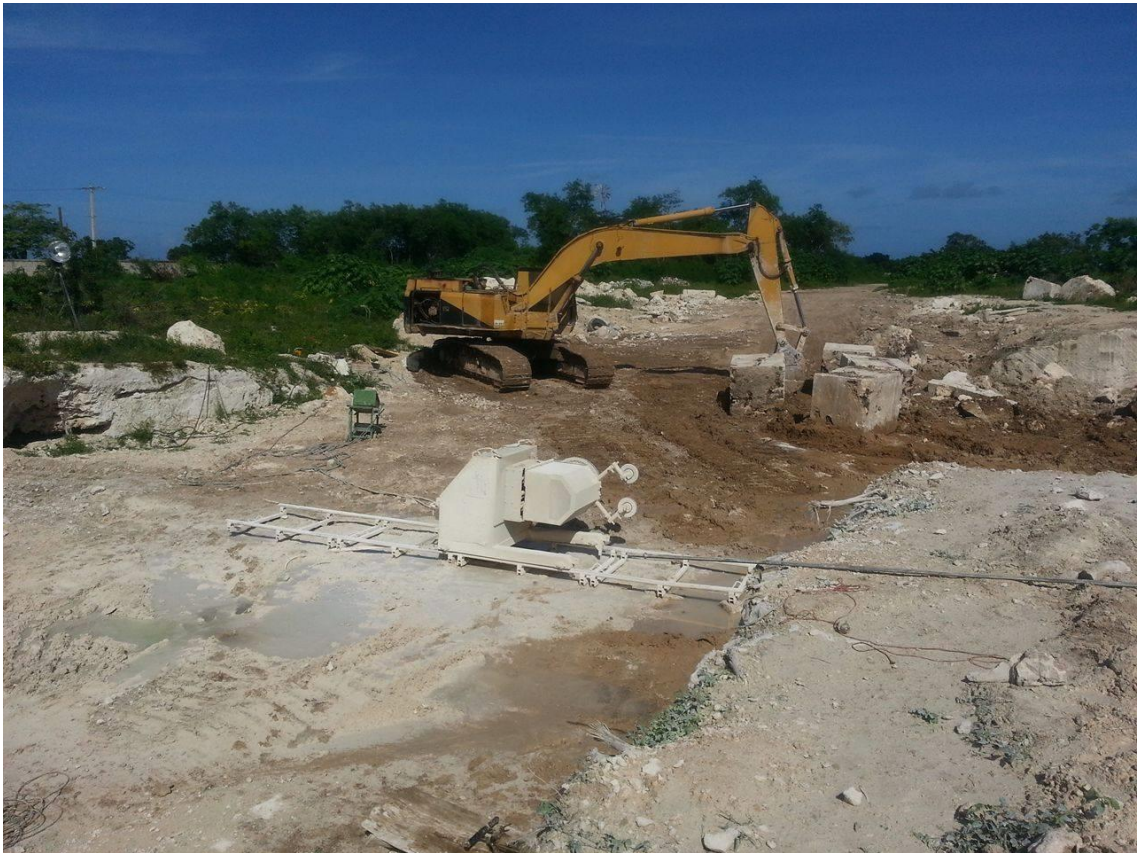
Máquina de hilo diamantado en una de la cantera de Coralina Del Este.
