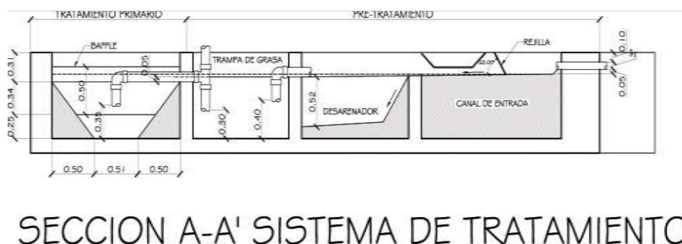
Gráfico No.4. Sección de sistema de tratamiento.
